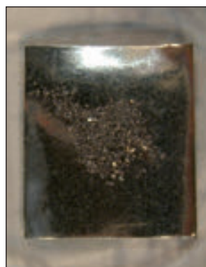
Obr. 5. Modelový vzorek cínové folie s nasýpanou \alpha modifikací.
