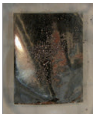
Obr. 5. Modelový vzorek cínové folie s nasýpanou \alpha modifikací.
