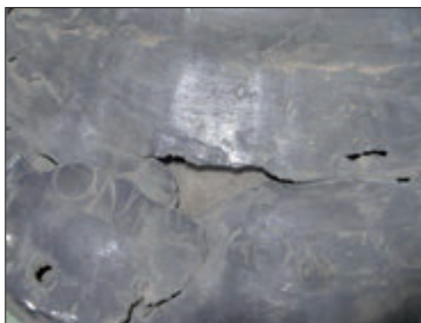
Obr. 3, 4. Trhlinami poškozené víko cínové křtitelnice z roku 1581; detail (křtitelnice je ve vlastnictví Národního muzea v Praze).
