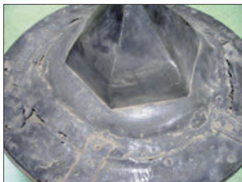
Obr. 3, 4. Trhlinami poškozené víko cínové křtitelnice z roku 1581; detail (křtitelnice je ve vlastnictví Národního muzea v Praze).
