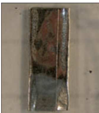
Obr. 5. Modelový vzorek cínové folie s nasýpanou \alpha modifikací.
